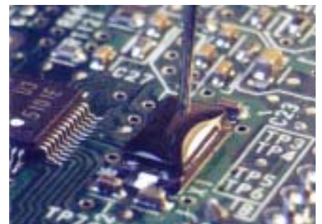
防湿コーティング剤の塗布作業
