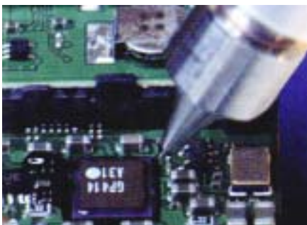
アンダーフィルの塗布作業
