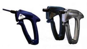
標準のビット、スリーブが使用できる手動式ワイヤラッピングツールです。ワイヤサイズφ0.2〜φ3.65mm (AWG22〜32) に適しています。 1回の有効回転数は約10回転ですので、ワイヤラッピングの巻数が10回以下になるようにワイヤのストリップ長を調節してください。フレームの材質はG100/R3278・G100/3278INSがアルミニウム、G200/R3278が強化プラスチックです。
