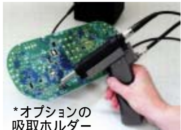
クワッド型チップによるIC除去
