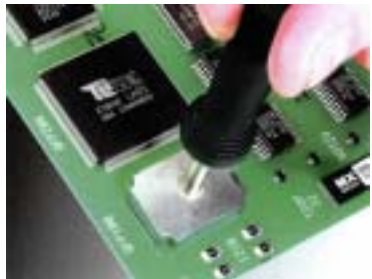
クワッド型チップによるIC除去
