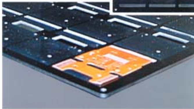
(写真:上・左) COFをキャリア にセットした様子
